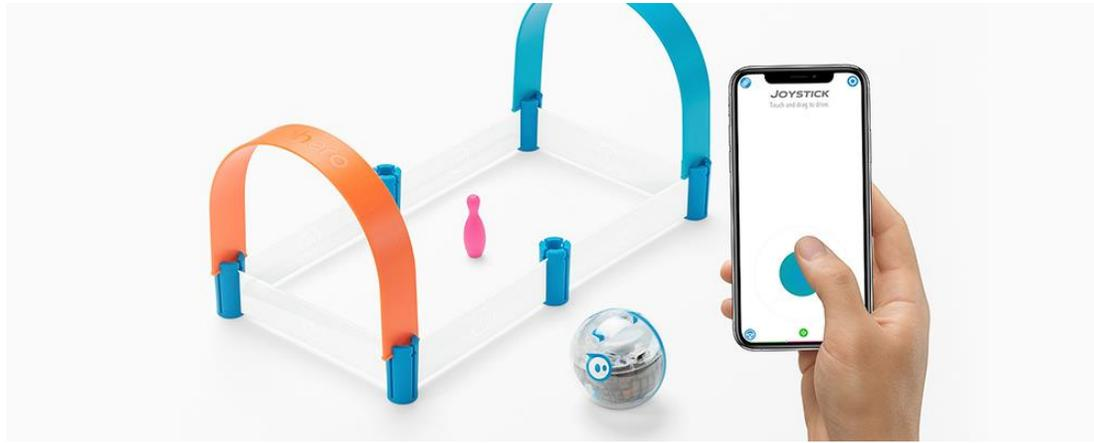
**Sphero Mini** هو روبوت بحجم كرة الجولف مزود بأضواء LED تتوهج في عدة ألوان مختلفة. يمكن التحكم في هذا الروبوت عن طريق هاتفك المحمول باستخدام تطبيق Sphero Play للألعاب وأيضا بواسطة جهاز التحكم عن بعد، أو باستخدام تطبيق Sphero Edu لممارسة البرمجة. بداخل علبة مجموعة Sphero ستجد بطاقات أنشطة وأنشطة للبناء ستمكنك من معرفة ما قد يفعله Sphero!
